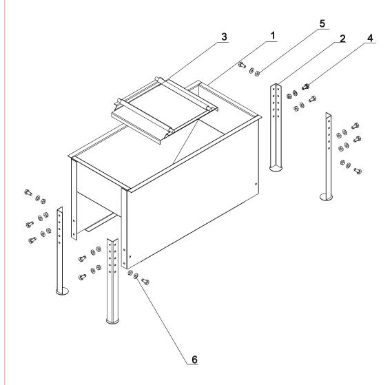
Рис. 1. Схема сборки щиномонтажной ванны.
